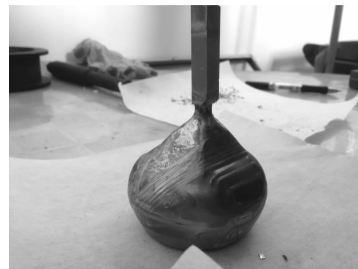
图 4 有保温罩下 \text{B}_2\text{O}_3 作为液封剂时生长的 GaSb 夹晶
