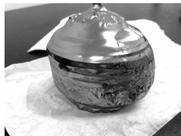
图 3 无保温罩下 \text{B}_2\text{O}_3 作为液封剂时生长的 GaSb 多晶
