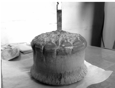
图 2 等摩尔比(LiCl+KCl)的混合物作为液封剂时生长的 GaSb 多晶
