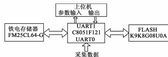
图 1 数据采集器结构原理图
