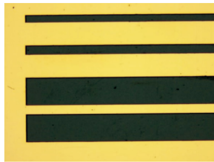
图 2 腐蚀 100 min 后完好的金属保护膜
