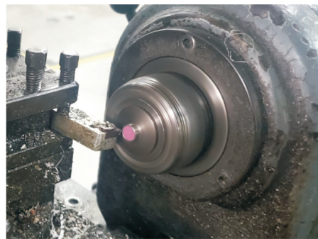
图8 换能器装夹切削
