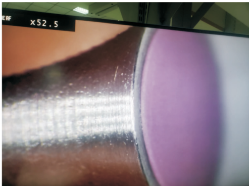
图 10 合格金属台阶形貌
