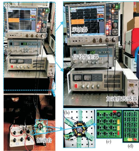
(a) 实验及测试装置; (b) PEH 压电单元; (c) MCP-SSHI 电路测试板; (d) SEH 电路测试板
